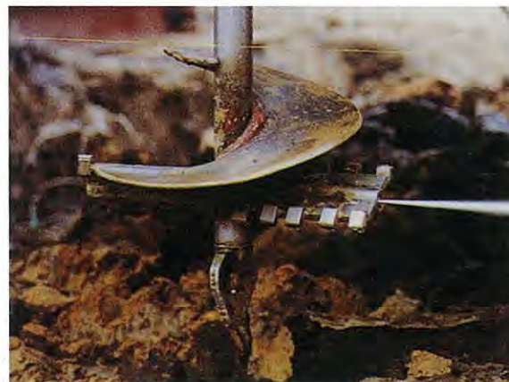
写真-5 機械排土型噴射モニター
