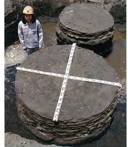
写真-6 LDis工法の改良体
