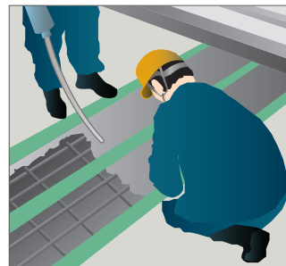
道路橋伸縮継手 (コンクリート)
